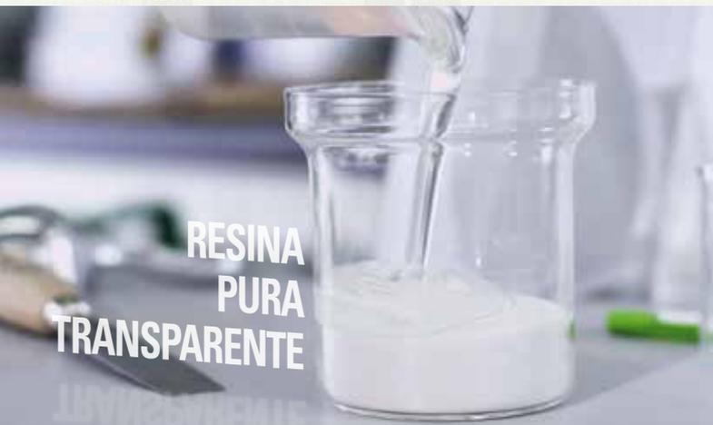
Fugalite® Eco Invisible es “vidrio” líquido obtenido a partir de una mezcla perfectamente calibrada de **finísimas perlas de vidrio puro** y una **resina exclusiva transparente**, idónea como adhesivo para la colocación y como rejuntado de los mosaicos vítreos. La óptima trabajabilidad y la facilidad de limpieza en fase de aplicación de Fugalite® Eco Invisible, aseguran **un rejuntado perfecto, liso, homogéneo**, que revaloriza las superficies cerámicas y mosaico vítreo.
